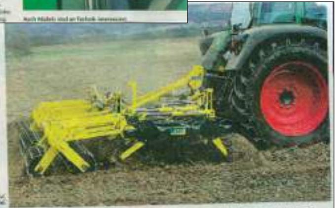
Made by LFS St. Andrä: An der Schule wurde dieses neue Gerät, die Saatbeetkombi, konstruiert und gefertigt.
