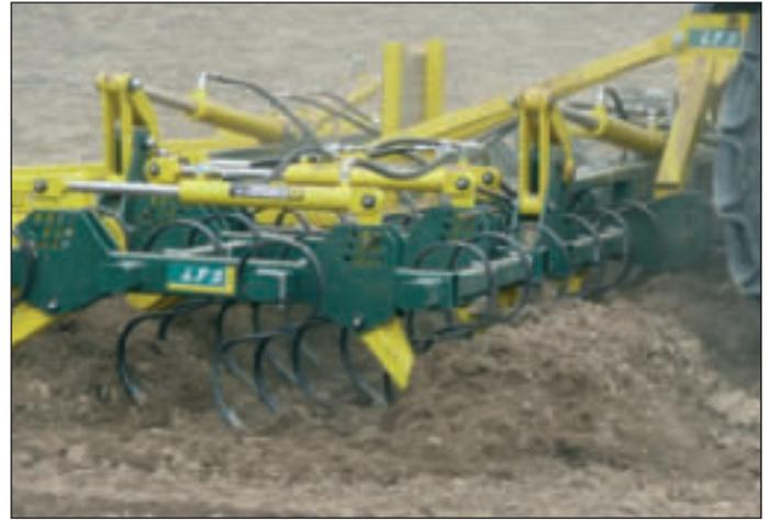
*Heuriges Großprojekt – eine Saatbeetkombination mit hydraulisch zuschaltbarem Steifblech*
